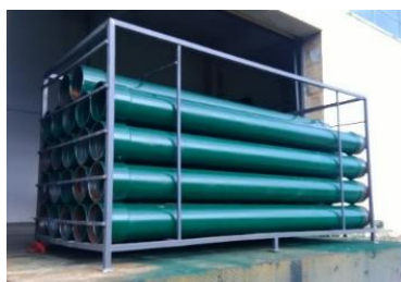
Coluna de betonagem
