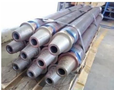
Varas de perfuração e revestimento
